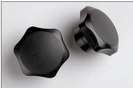
Insert taraudé en laiton. PF: Bakelite noire FS 31 DIN 7708.
