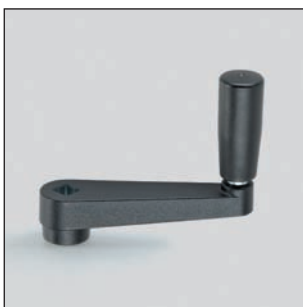
Poigné cylindrique rotative avec trou carré. Corp de Manette: Zamac (alliage de zinc, aluminium, cuivre) revêtement plastique, noir, mat. AL: Aluminium, revêtement plastique, noir, mat. Poigné cylindrique: PF: Duroplast noir 31. Alternative aux manivelles DIN 469.
