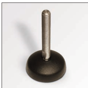
Tige filetée en acier inoxydable AISI-304. Base en PA: Polyamide renforcé. *Poids max.statique (tige verticale). Autres longueurs de tige: veuillez svp nous consulter. Disque antiglisse optionnel en PVC noir. Livré non assemblé au pied. Ø 40 mm Référence: 4250 01 040 Ø 50 mm Référence: 4250 01 050
