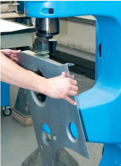
Dressage et ajustement d'une pièce moulée au niveau du fuselage de l'Airbus A340.
