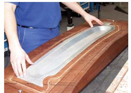
Dressage d'une pièce de revêtement au niveau du sol du nouvel Airbus A380 avec le Kraftformer KF 460.
