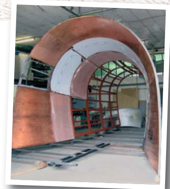
Formage en 3 dimensions de segments de tôle en feuille pour une entrée d'Hotel.
