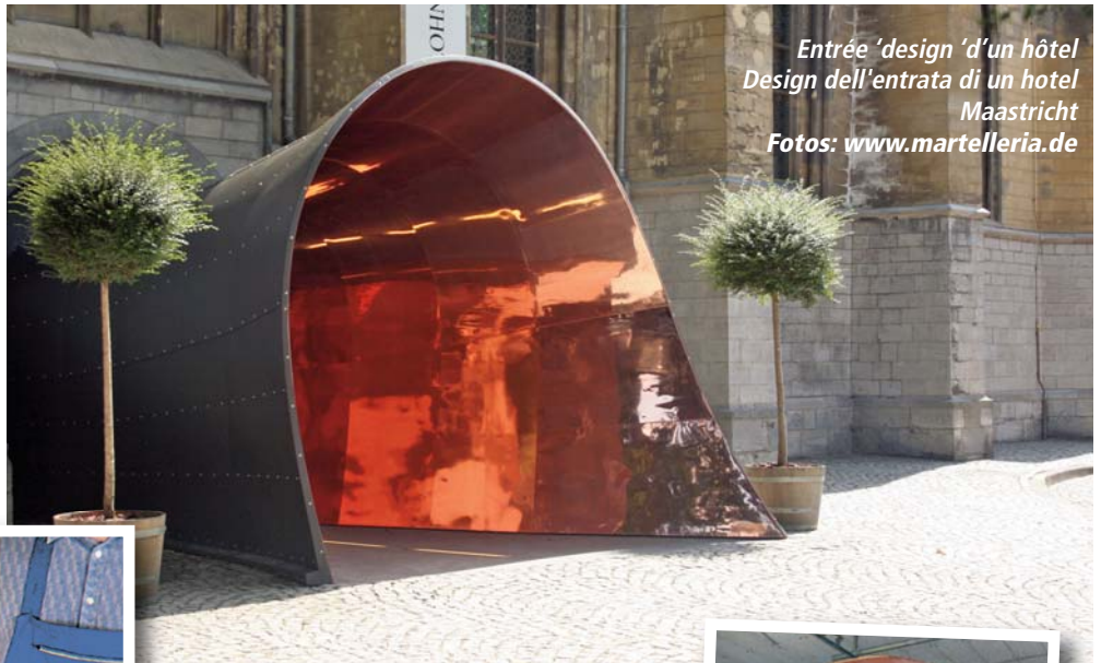
Formage en 3 dimensions de segments de tôle en feuille pour une entrée d'Hotel.
