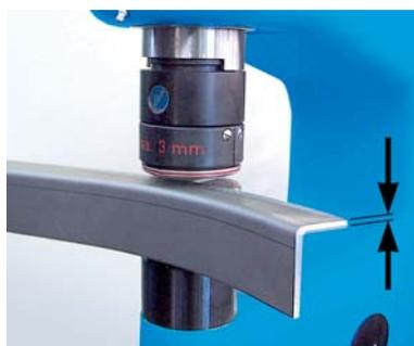
**+50% plus de capacité de formage** que le KF 324, allant jusqu'à 3 mm pour rétreint et l'allonge.
