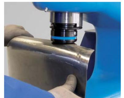
Le KF 324 pour le formage de tôle jusqu'à 2 mm.
