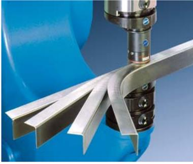
Le procédé ECKOLD, c'est la précision, la rapidité et l'assurance d'un formage à froid de qualité pour vos tôles et profilés. Avec une seule machine vous cintrez, formez et ajustez vos pièces, qu'elles soient neuves ou en réparation. L'universalité de cette technologie est unique.
