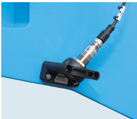
Integrierter Laserpointer zur Bauteil-Positionierung Integrated laser pointer for positioning of components
