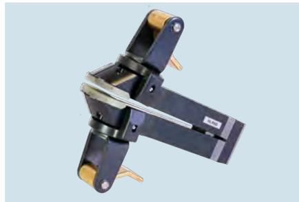
Outil à bec type HLR 60 pour l'allongement des profilés en U avec une faible hauteur d'âme. Équipé de surfaces de contact adhésives en plastique pour rétreindre sans endommager la surface, spécialement pour les métaux légers et l'acier inoxydable.
