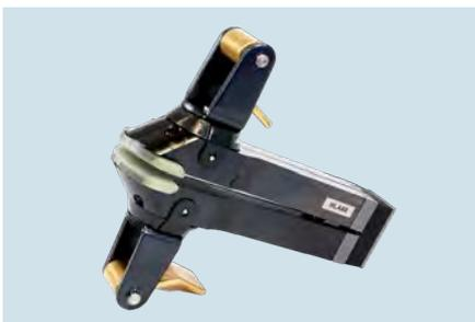
Outil à bec type HLA 60 pour le rétreint de profilés en U avec une faible hauteur d'âme. Équipé de surfaces de contact en plastique adhésives pour rétreindre sans endommager la surface, spécialement pour les métaux légers et l'acier inoxydable.
