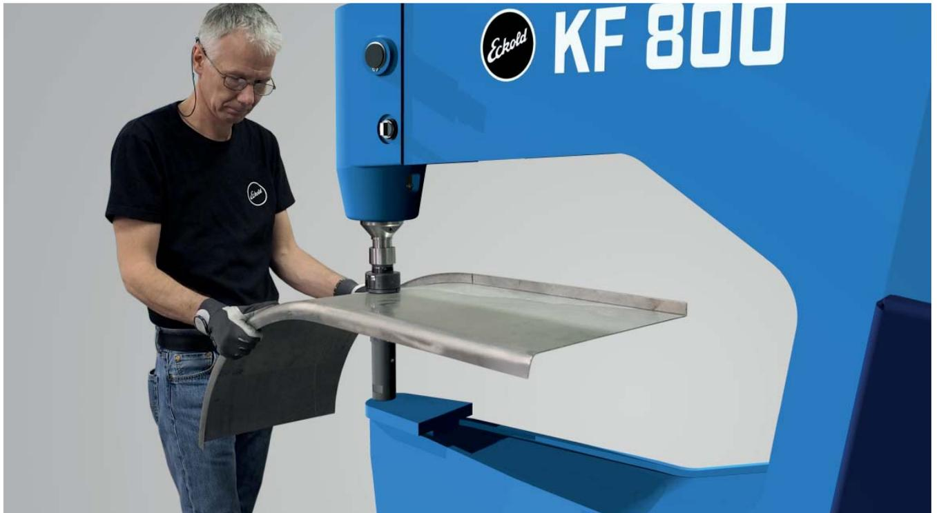
Le procédé ECKOLD, c'est la précision, la rapidité et l'assurance d'un formage à froid de qualité pour vos tôles et profilés. Avec une seule machine vous cintrez, formez et ajustez vos pièces, qu'elles soient neuves ou en réparation. L'universalité de cette technologie est unique, en particulier le formage par rétreint.
