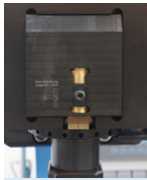
Verstellbare Wegbegrenzung adjustable path limitation
