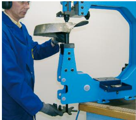
Réglage fin de la pression de travail.
