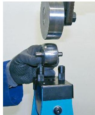
Changement rapide des rouleaux inférieurs.
