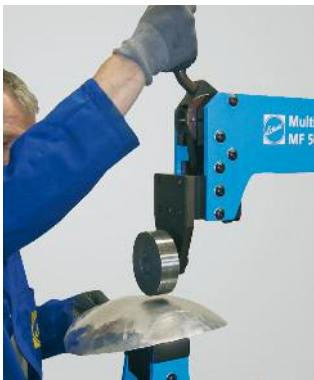
Poignée de serrage pour serrer ou desserrer la pièce.
