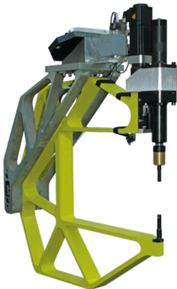
Sonderclinchbügel (gewichtsoptimiert) / Special clinching frame (weight-optimised)
