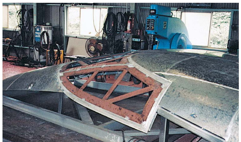
Formatura su misura di lamiera.
