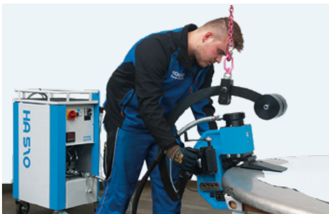
Hydraulikaggregat mit mobilem Kraftformer zum Bördeln. / Hydraulic drive unit with portable Kraftformer for flanging.
