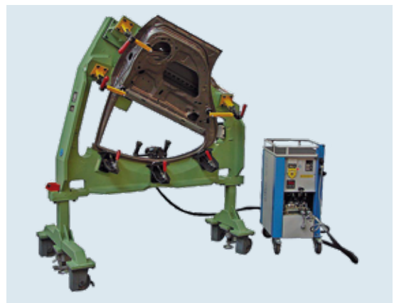
Hydraulikaggregat mit Falz zange / hydraulic drive unit with seamclosing pliers
