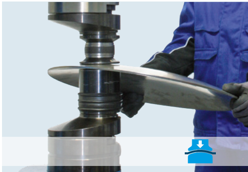
Wölben (Bombieren) von Blechen / Doming sheet metal
