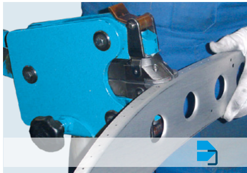
Anpassen mit oberflächenschonendem Werkzeug / Adjusting with no-mar tools
