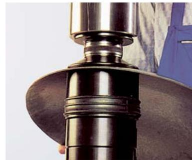
Der ECKOLD Kraftformer KF 340 gehört der mittleren Kraftformer-Reihe an. Ein besonderes Merkmal der Maschine ist die stufenlos einstellbare Geschwindigkeit von 250 - 550 Arbeitstakten pro Minute.
