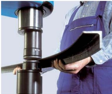
Umformen durch genau kontrolliertes Stauchen.
