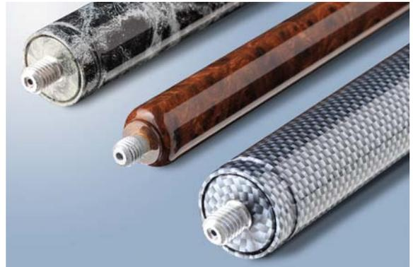
Les décors sont appliqués suivant un procédé nommé "dip-print". Cette technique utilise un film hydrosoluble appliqué au corps en acier inoxydable avec une haute pression d'eau. Le résultat est lisse, parfaitement adhérent et indélébile. Un vernis haute résistance est ensuite appliqué pour protéger efficacement les surfaces traitées contre les agressions mécaniques.
